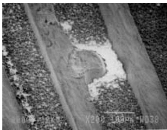
スラッジ再付着によるエッチング残り
